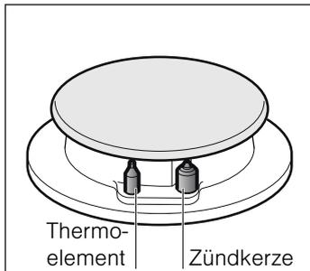
Um sicherzugehen, dass diese Vorrichtung aktiv ist:
