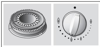
Flamme extérieure à puissance minimum, flamme intérieure à puissance maximum.
