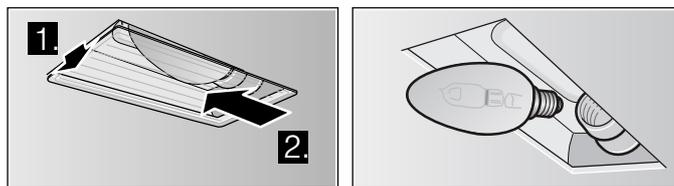
3. Lampafscherming aanbrengen.
