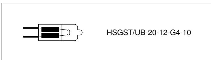
**Napomena:** Halogene žarulje se kod umetanja ne smiju dodirivati za stakleni dio. Za umetanje halogenih žarulja koristite čistu krp.
