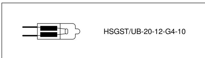
**Upozornění:** Při nasazování halogenových žárovek se nesmíte dotknout skleněné baňky. Při nasazování halogenových žárovek použijte čistý hadr.
