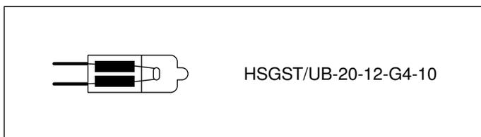
**Anvisning:** Ta inte på halogenlampornas glashölje vid lampbyte. Håll halogenlampan med ren trasa när du sätter i den.
