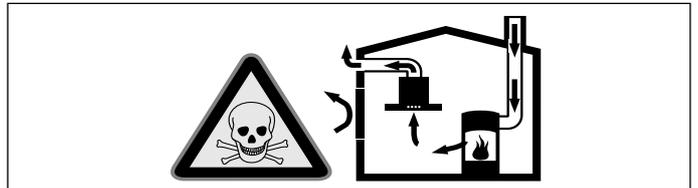
A belső levegőtől függő tűzhelyek (pl. gáz-, olaj-, fa- vagy széntüzelésű fűtőberendezések, átfolyós vízmelegítők, melegvízkészítő rendszerek) elszívják az égéslevegőt a felállítási térből, és egy füstgáz-berendezésen (pl. kürtőn) keresztül a szabadba vezetik az elhasznált gázt.
