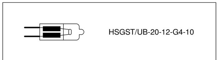
**Remarque :** En insérant les ampoules halogènes, veiller à ne pas toucher le ballon de verre. Pour insérer les ampoules halogènes, utiliser un chiffon propre.
