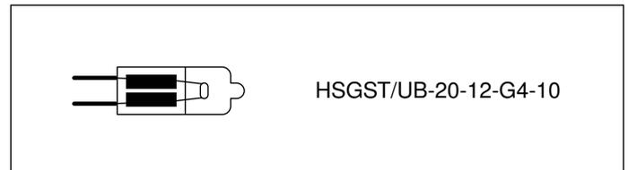
**Avvertenza:** Durante l'installazione, le lampadine alogene non devono essere toccate in corrispondenza del bulbo di vetro. Per installare le lampadine alogene utilizzare un panno pulito.
