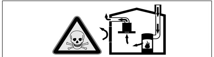
Kurišča, odvisna od zraka v prostoru (npr. grelne naprave na plin, olje, les ali premog, pretočni grelniki, bojlerji) črpajo zrak za izgorevanje iz prostora, v katerem so nameščeni, in odvajajo izpušne pline prek sistema za odvajanje plinov (npr. dimnika) na prosto.
