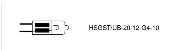
**Aanwijzing:** Het glas van halogeenlampen mag bij het aanbrengen niet worden aangeraakt. Gebruik bij het aanbrengen van de halogeenlampen een schone doek.
