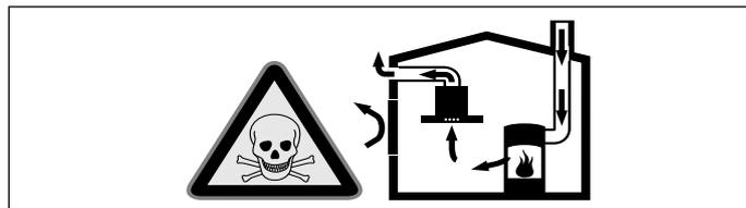
Grijala na plamen koja ovisе o zraku iz prostorije (npr. plinska grijala, grijala na ulje i drva ili ugljen, protočni grijači vode, uređaji za pripremu tople vode) troše zrak za sagorijevanje iz prostorije u kojoj je postavljen uređaj i odvođe dimne plinove kroz dimovodne uređaje (npr. dimnjak) na otvoreno.
