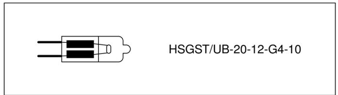
**Indicație:** Lămpile cu halogen nu trebuie atinse de balonul de sticlă la montare. Pentru montarea lămpilor cu halogen, folosiți o cârpă curată.
