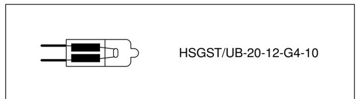
**Nota:** Las bombillas halógenas no deben agarrarse por el foco para su colocación. Para colocar las bombillas halógenas, utilizar un paño limpio.
