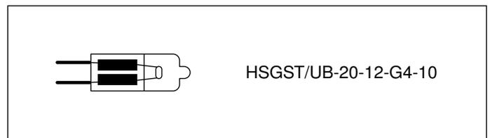
**Hinweis:** Halogenlampen dürfen beim Einsetzen nicht am Glaskolben berührt werden. Zum Einsetzen der Halogenlampen ein sauberes Tuch verwenden.
