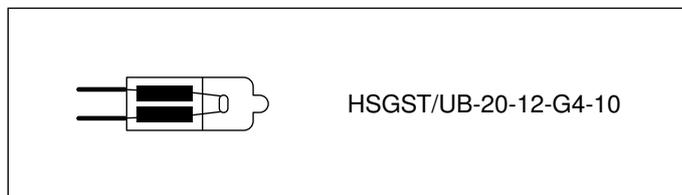
**Nota:** Ao inserir lâmpadas de halogéneo, não toque no êmbolo de vidro. Para inserir as lâmpadas de halogéneo, utilize um pano limpo.
